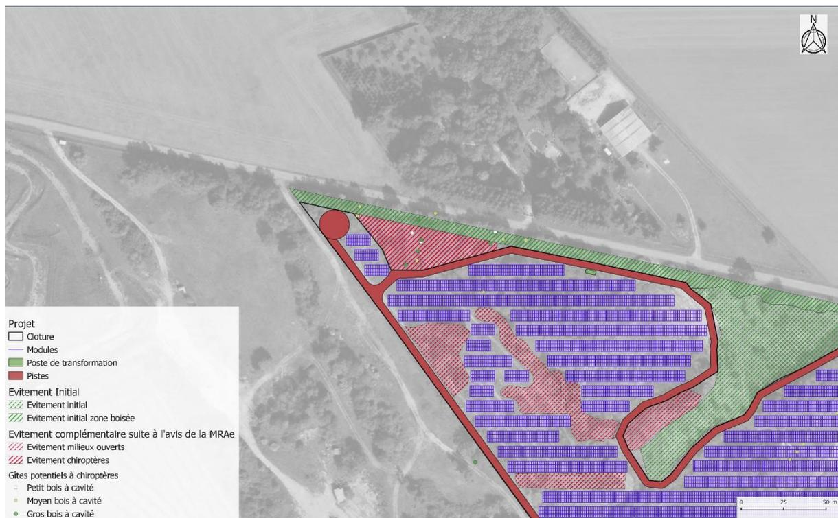
Ces modifications entraînent logiquement une réduction de la puissance installée de la centrale qui passe de 5,4 MWc à 4,3 MWc.
